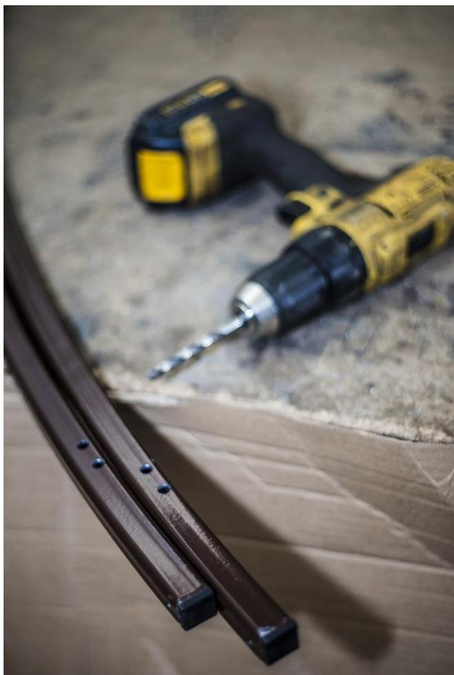
Просверлить в каждой арке по 4 отверстия диаметром 7-8мм.
