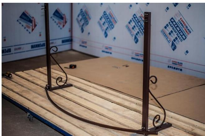
Вложить в уголки кронштейнов арки, выставив их равномерно относительно кронштейнов. Скошенный край уголка не должен выходить за линию арки. Разметить по существующим уголкам отверстия в арках.
